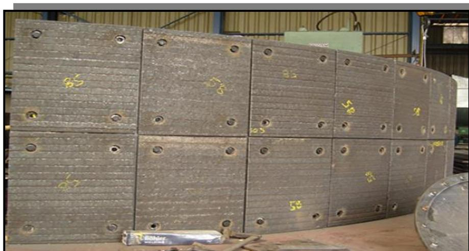
As chapas bimetálicas podem ser cortadas pelo processo de corte Plasma. Apesar das propriedades excelentes ao desgaste, as chapas podem ser trabalhadas a frio e soldadas. Podemos fornecer o corte dos perfis adequado à solução para cada cliente, podendo também ser fornecidas fabricações e estruturas, completas de acordo com o projecto e equipamentos do cliente, previamente cortadas.
